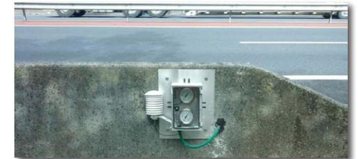
Ne nécessitant ni étalonnage régulier, ni maintenance conséquente, il présente l'avantage de limiter l'exposition des agents aux intempéries ou aux dangers de la circulation tout en permettant un relevé rapide des données au moyen des tablettes embarquées.
