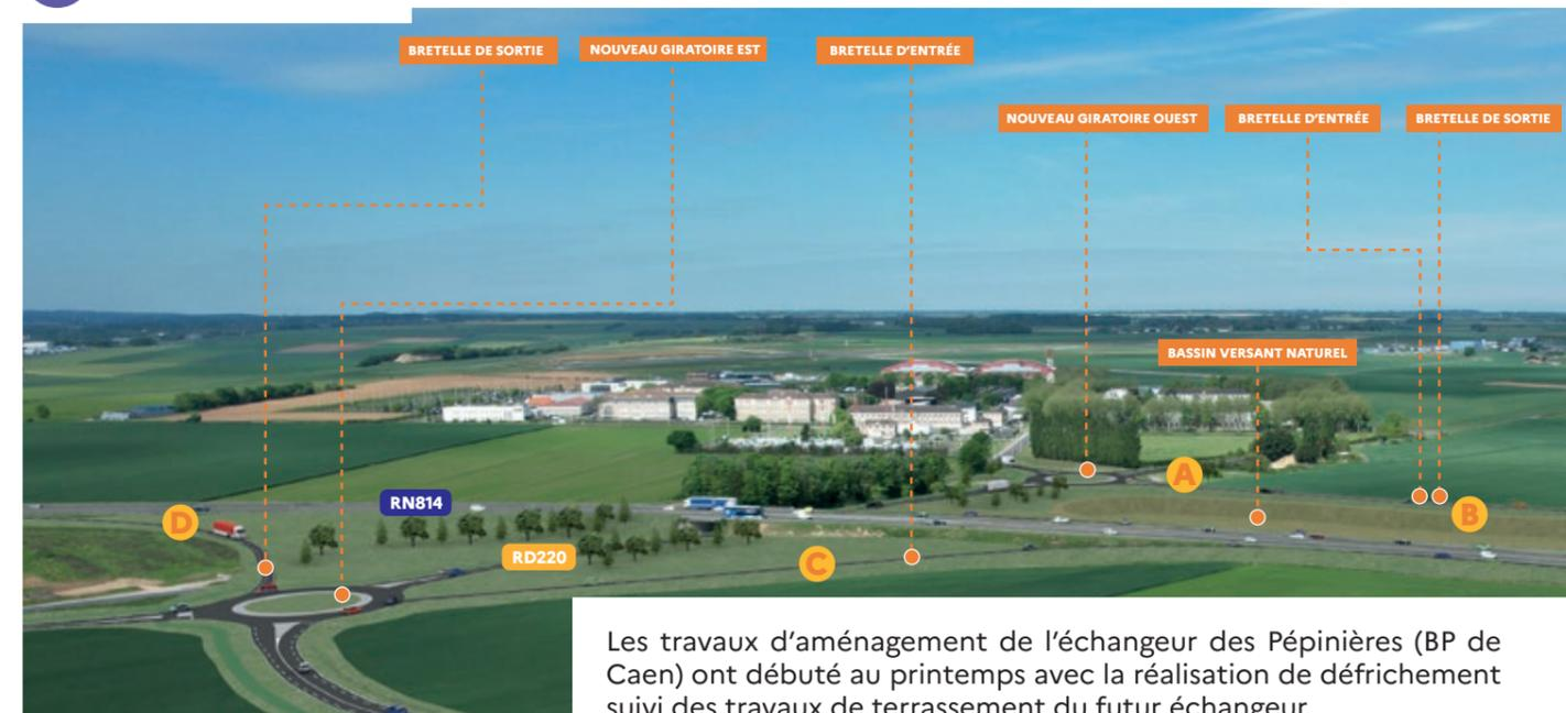
Les travaux d'aménagement de l'échangeur des Pépinières (BP de Caen) ont débuté au printemps avec la réalisation de défrichage suivi des travaux de terrassement du futur échangeur.
